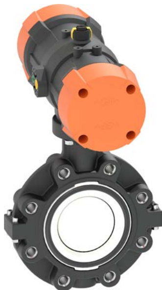
SYGEF standaard lugtype, eindbouwvlinderklep type 243 (578 met PPA) FC (drukloos gesloten) flensaansluiting standaard metrisch
